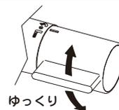
急に回して「ドン」という音がしたときは、配管に負荷がかかり破損・漏水の原因となります。
