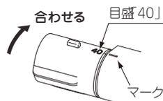
5. 水側と同様に湯側(左)の流量調節栓を調節します。
