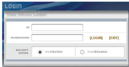
WEB Clientのログイン画面が出ると、“WEBWATCH”(ウェブ監視)または“WEBSEARCH”(ウェブ検索)を選択します。ID及びパスワードを入力して[LOGIN]ボタンをクリックすると選択したモードに接続されます。
