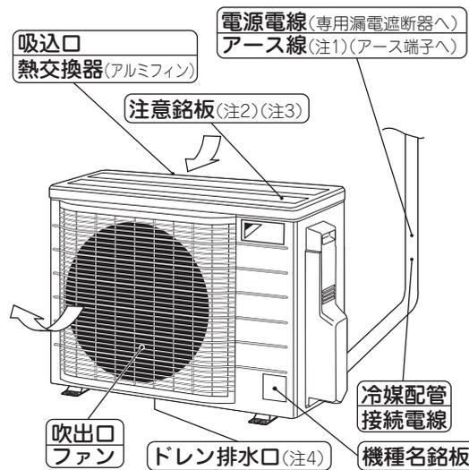
(注1) アース線は、万一の感電・火災防止のため室外ユニットから大地へ電気を逃がす線です。
